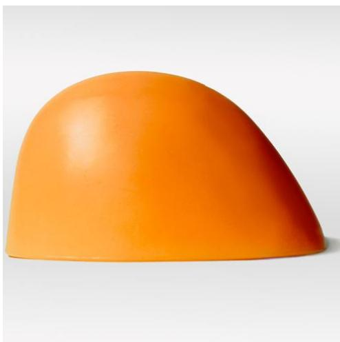
Embout en matériau polymère avec résistance aux chocs à 200J selon EN 20345. Cet embout non magnétique et léger isole thermiquement le pied offrant une meilleure protection.
